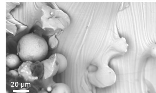
Surface d'un alliage de titane (Ti-6Al-4V) additionnellement fabriqué par fusion au laser sélective, montrant des régions entièrement fondues le long de particules Ti-6Al-4V non fondues et autre matériau. Image capturée avec le détecteur BSE sur ZEISS EVO 15. Échantillon fourni par TWI Ltd.
