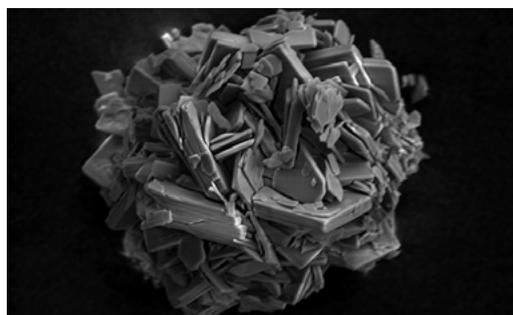
Imagerie C2D avec effet de charge réduit de façon drastique
