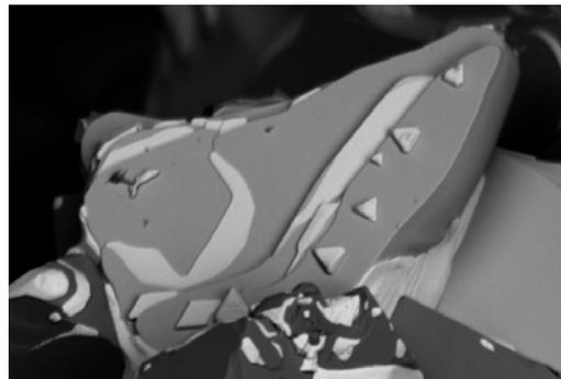
Image de céramique BiCaCo capturée avec le détecteur BSE basse kV à une énergie de 5 kV, les BSE donnent de forts contrastes de matériaux.
